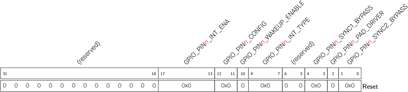
Register 5.18. GPIO_PIN n _REG ( n:0-46 ) (0x0074+4* n )
